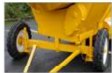
as pernas de elevação são descidas durante a mistura para estabilidade, do eixo giratório dianteiro que auxilia a manobrabilidade local
