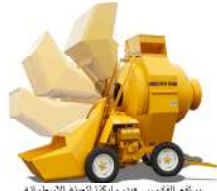
يرتفع القنادوس هيدروليكيًا لتعبئة الأسطوانة
