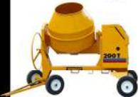
**200T (10 / 7)** - 200 litros de caudal de salida de lote húmedo 285 litros de capacidad seca sin mezclar hasta 2,4m<sup>3</sup>/hora motor de arranque eléctrico Yanmar o diesel de arranque manual Lister Petter
