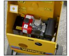
Moteur diesel Yammar L48 à démarrage électrique
