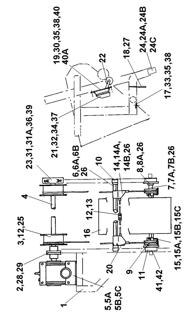
RP400XD LOADER C/W COMBINED MOTOR, BRAKE & GEAR UNIT
