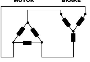
THREE PHASE A.C. BRAKE CONNECTED ACROSS MOTOR TERMINALS. DIRECT-ON - LINE STARTING METHOD ONLY
